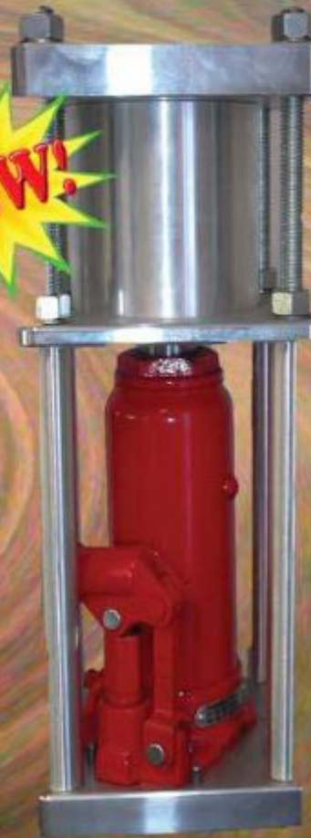
"Jack-Patty" 6 ton Hydraulic Press
